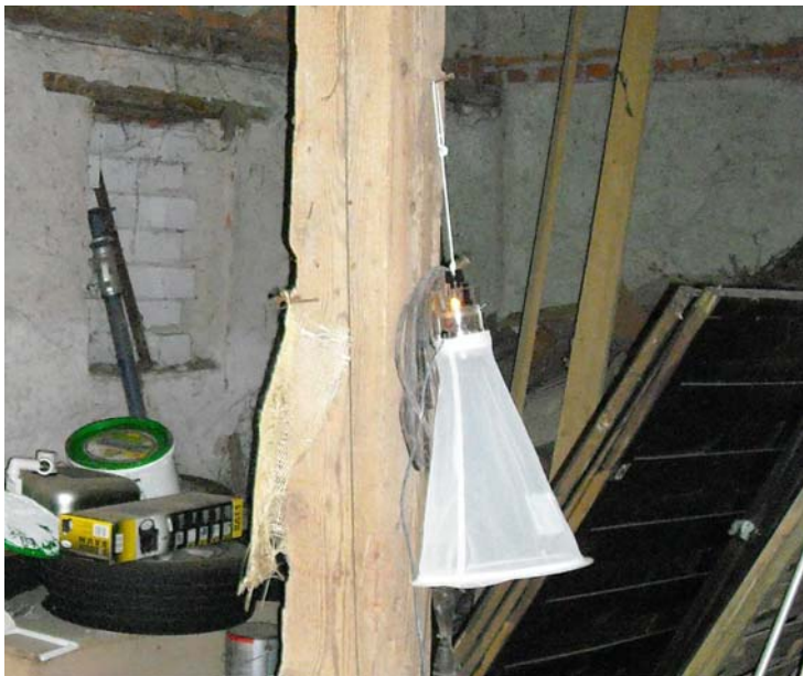
Abb.1: Lichtfalle vom Typ „CDC Miniature Light Trap 512“
